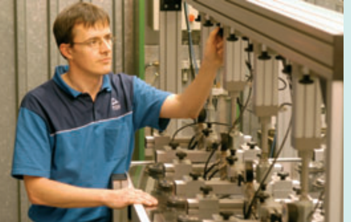
Die Belastbarkeit eines Kollektors für Solarwärmanlagen wird in Prüfeinrichtungen ausgiebig getestet.
